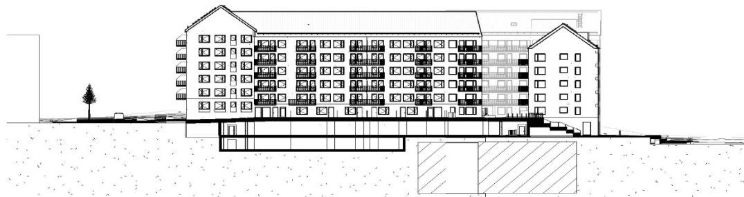
Bild 24. Sektion D-D, tvärsektion med vy västerut. (Skrafferingen avser dagvattentunnelns skyddsområde.)
