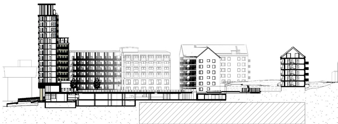
Bild 23. Sektion A-A, längssektion med vy söderut. (Skrafferingen avser dagvattentunnelns skyddsområde.)
