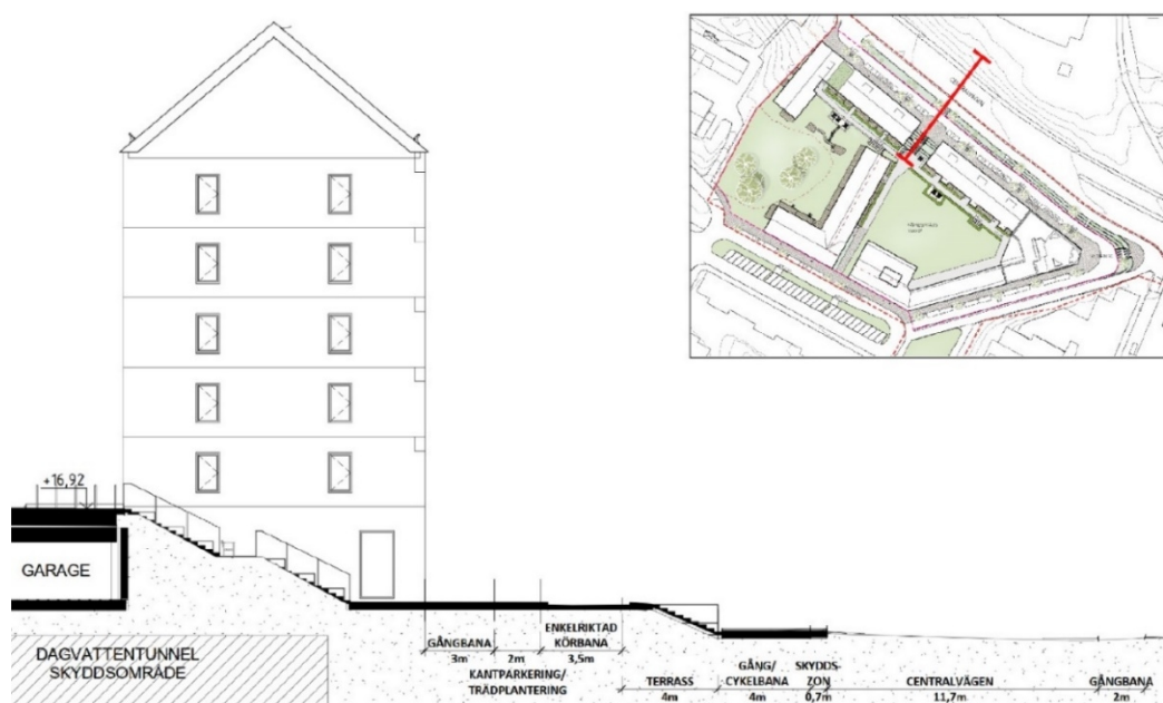
Bild 34. Sektion för lokalgatans sträckning längs Centralvägen, Tyréns
