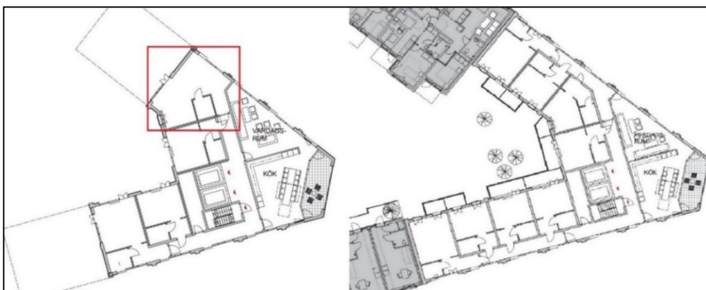
Bild 43. T.v. illustreras planlösningsförslaget för den övre delen (våning 9-14) och t.h. visas förslag på planlösning för våning 1-8. I det fortsatta arbetet måste fokus läggas på att få till en fungerande planlösning för de rödmarkerade lägenheterna.
